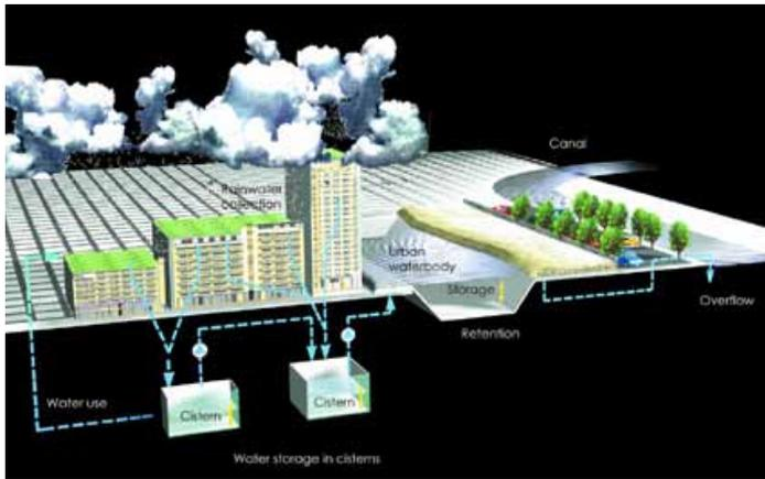
Figure 8. Water Recycling System (Dreiseitl)
